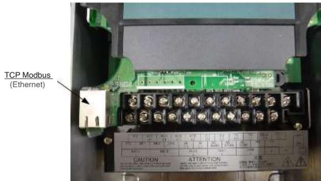
**Figura 5.18** Posição do conector Ethernet
