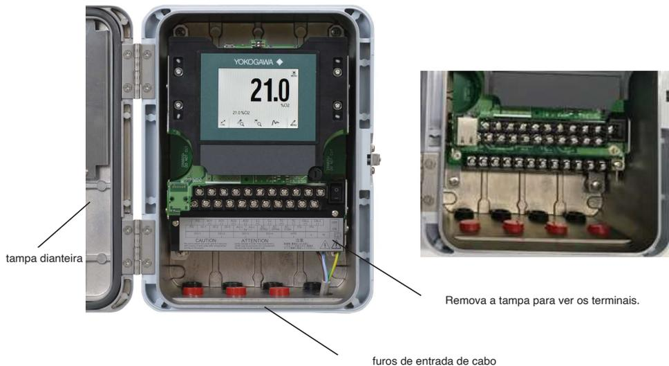
Figura 5.1 Terminais para fiação externa no conversor
